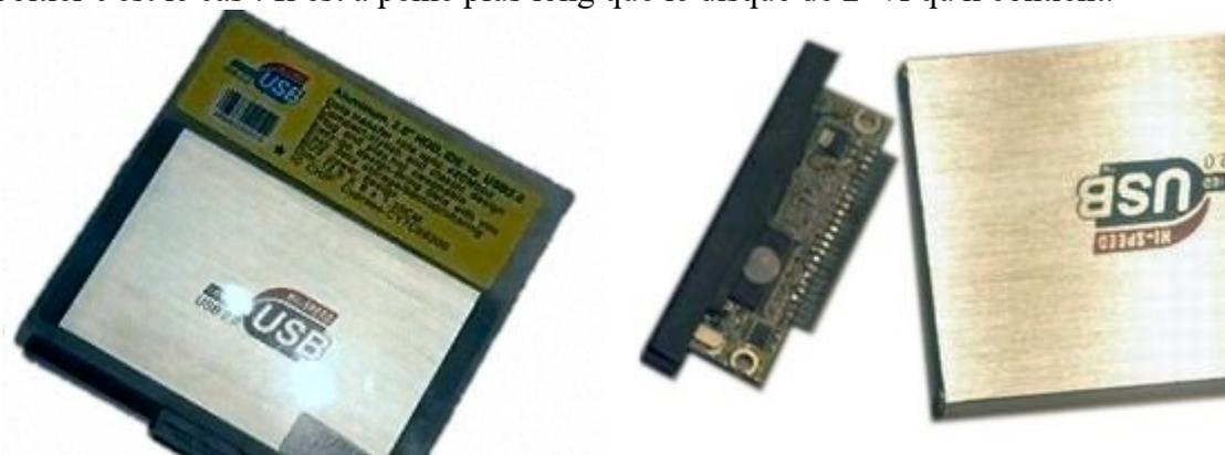
2 vis à défaire, le disque à brancher sur le connecteur, puis les 2 vis à fixer et le tour est joué.
