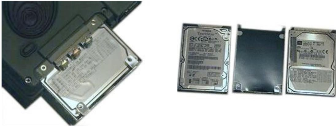
Le montage dans l'Acer TM803 n'a causé aucun problème. Extraction de l'ensemble disque et berceau, séparation du berceau, fixation du berceau sur le 7k60, et réinsertion dans le portable.
